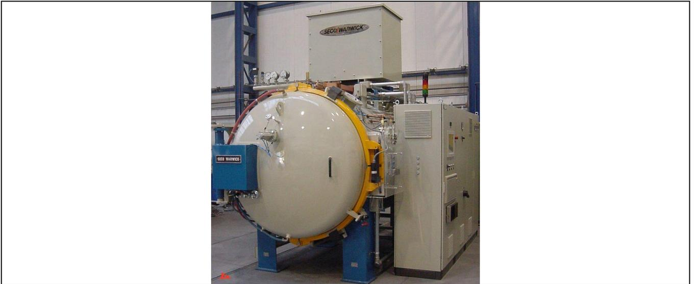
Figura 2 – Forno a vácuo Seco/Warwick de 12 bar de pressão de gás nitrogênio no resfriamento. F. SW
