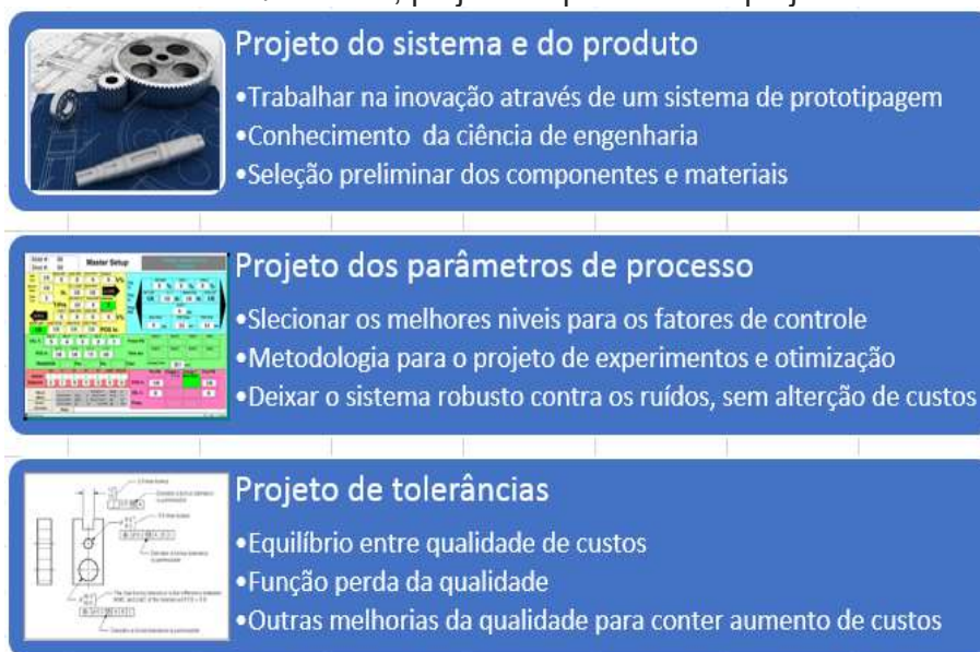
Figura 4 - Três diferentes métodos na metodologia Taguchi: projeto do sistema/conceito, projeto do parâmetro e projeto da tolerância.
