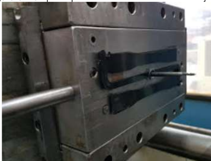
Figura 5 – Corpo de prova na cavidade do molde de injeção.
