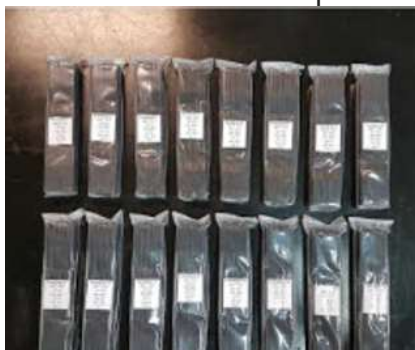
Figura 7 - Corpos de prova embalados com silica para envio ao laboratório de ensaios
