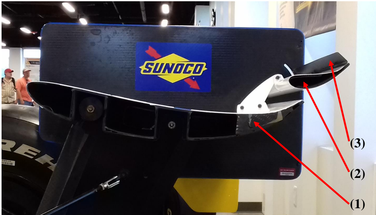
Figura 2 – Exemplo de conjunto de asa traseira de um Fórmula Indy moderno, onde observa-se a asa principal (1) e a asa secundária (2), dotada de Gurney Flap (3). Fonte: O Autor
