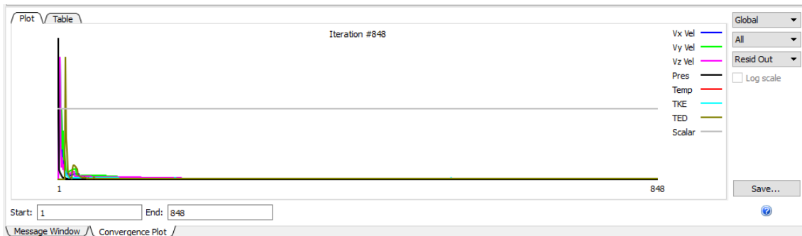
Figura 8 – Representação gráfica do software Autodesk CFD, o qual é possível observar a progressão dos valores residuais oriundos das iterações até a convergência. O autor.
