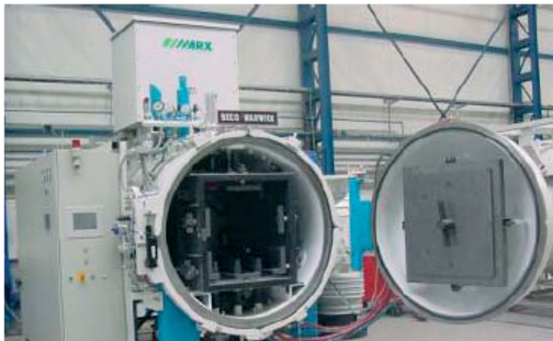
Figura 1 – Forno a vácuo com câmara de seção retangular. Foto SW
