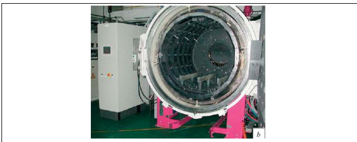
Figura 3 – Forno a vácuo (com porta aberta) de câmara cilíndrica.
