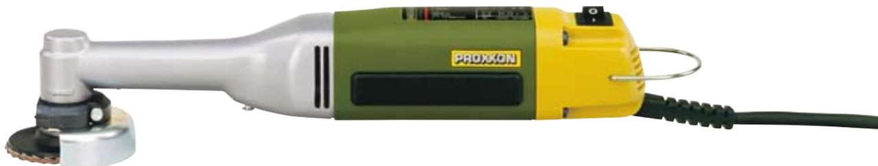
**Para trabalhar em aço, metais não ferrosos, vidro, cerâmica, madeiras e plásticos.** Serve para cortar, rebarbar, esmerilar, lixar, polimentos finos e desbaste de madeiras. Robusto e durável, motor CC especialmente balanceado e silencioso. Carcaça feita de Poliamida reforçada a fibra de vidro. Fornecido no conjunto um disco de Corindo grão 60, uma lixa de lamelas grão 100 e um disco de corte reforçado. Fornecido em estojo de Polipropileno conforme descrito anteriormente.
