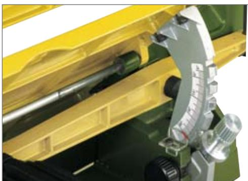
Possibilidade de ajuste angular a partir de 5° até 50°, entalhes maiores nos 0°, 10°, 20°, 30° e 45°. Ajuste fino adicional para esquadrias e cortes mais precisos.
